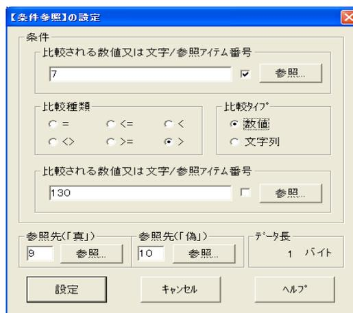
発行する際は、図④-1,2 のように呼び出される商品の価格によって、このひとつのフォーマットだけで、2種類の印字内容を自動的に選択して発行されます。
